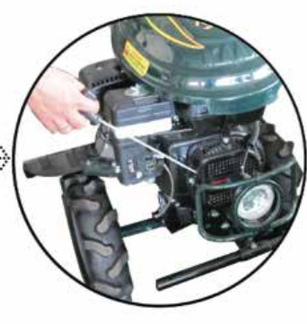
İp Çekme Kolunu Çekiniz. Motor Çalıştıktan Sonra Jikle Kolunu Kapalı A Konumuna Geri Getiriniz
