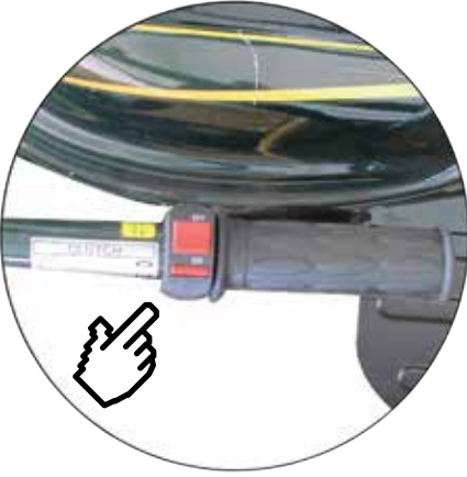
Motor Stop Düğmesini Açık (ON) Konumuna Alınız
