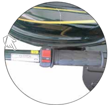
Motor Stop Düğmesini Kapalı (OFF) Konumuna Alınız
