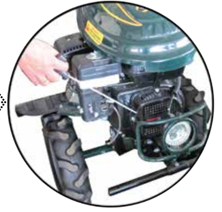
İp Çekme Kolunu Çekiniz. Motor Çalıştıktan Sonra Jikle Kolunu Kapalı A Konumuna Geri Getiriniz
