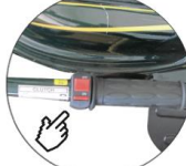
Motor Stop Düğmesini Açık (ON) Konumuna Alınız
