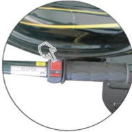
Motor Stop Düğmesini Kapalı (OFF) Konumuna Alınız
