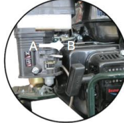
Jikle kolunu (Kapalı) A konumundan B (Açık) Konumuna Alınız
