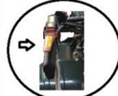
Acil durumlarda Otomatik stop koluna bırakmanız yeterlidir
