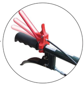
3) Güvenlik Kolulunu İndiriniz Bu Kol Aynı Zamanda Stop Koludur
