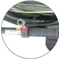
Motor Stop Düğmesini Kapalı (OFF) Konumuna Alınız
