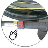
Motor Stop Düğmesini Açık (ON) Konumuna Alınız
