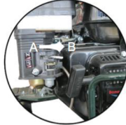
Jikle kolunu (Kapalı) A konumundan B (Açık) Konuma Alınız (Jikle kolunu A konumunda çalıştırdıktan sonra B konumuna alınız.)
